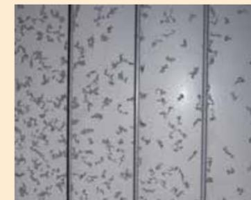
ガルバリウム鋼板の非雨掛かり部での腐食
