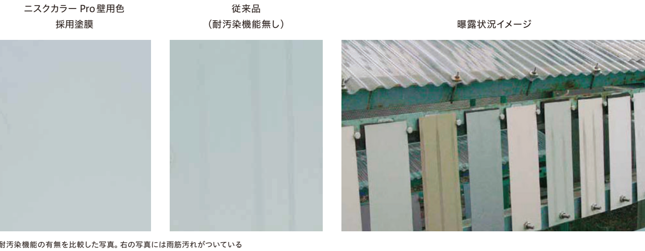
耐汚染機能の有無を比較した写真。右の写真には雨筋汚れがついている
