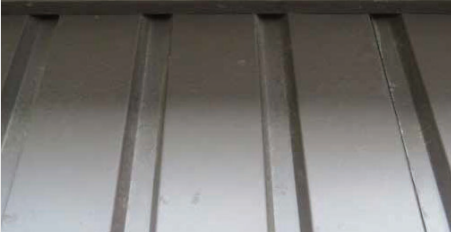
（b）塗装SGL：平面・加工部の耐白錆性向上
