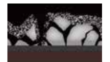
アルミ系酸化生成物が充填される前に犠牲防食作用が働かなくなり、腐食が進行してしまう。
