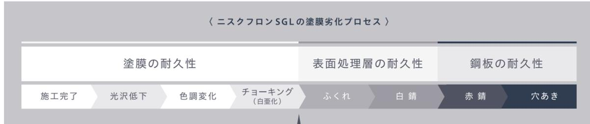
ニスクフロンSGLの塗膜面がチョーキングの末期状態でふくれが散見される状態が塗り替えの適正時期と見なせます。塗り替え塗料には、各塗料メーカーより各種塗料が市販されていますので、使用環境、耐用年数など勘案の上、施工工事業者とご相談ください。
