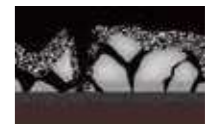
アルミ系酸化生成物が充填される前に犠牲防食作用が働かなくなり、腐食が進行してしまう。
