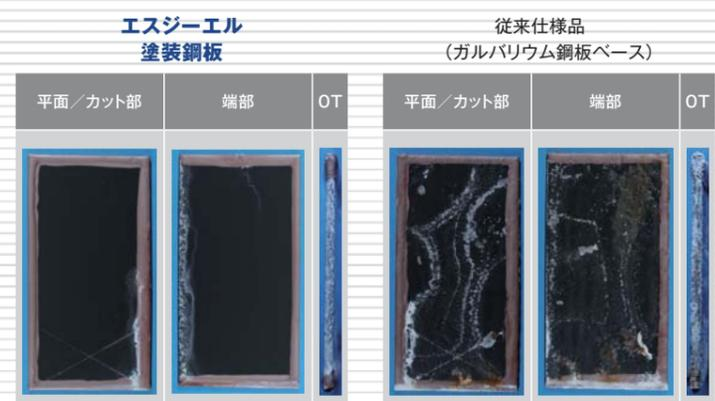
エスジーエル塗装鋼板は原板の耐食性が高いため、厳しい腐食環境に置かれても、従来仕様品に比べ塗膜を良好な状態に保っています。端面腐食の抑制効果との相乗で、長期使用はもちろん商品の外観維持にも貢献します。
