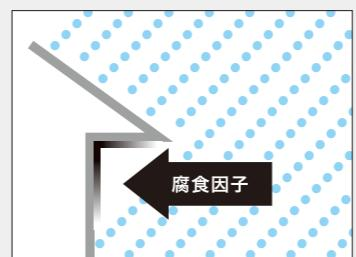
軒下部に塩分が付着・堆積すると雨により洗い流されない事に加え、日が当らず乾燥しにくいため、濡れ時間が長くなり、腐食が促進されます。
